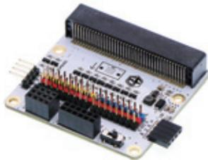
Octopus:bitは、micro:bit用のブレイクアウトボードの一種です。micro:bitボードのGPIOポート、シリアルポート、IICポート、SPIポートを引き出すことができます。Octopus:bitの最大の機能は、一部のGPIOポートの電気レベルを切り替えることができることです。これにより、micro:bitを5Vセンサーに適合させることができます。
