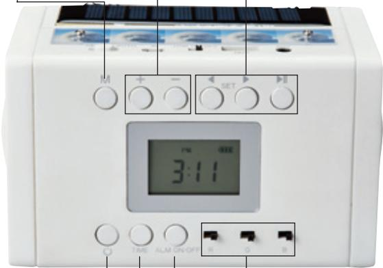
電源スイッチ 時計設定 アラーム設定 液晶バックライト
