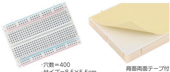
穴に品やリード線を差すだけで回路が組み立てられる。試作回路の回路チェックや動作確認に。アナログ回路の抵抗等の定数決定に
