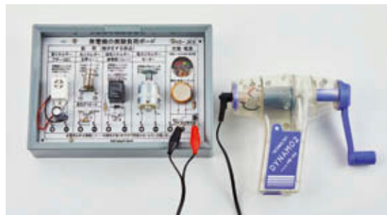
付属の発電機を使い、部品に電気負荷をかけて実験します。
