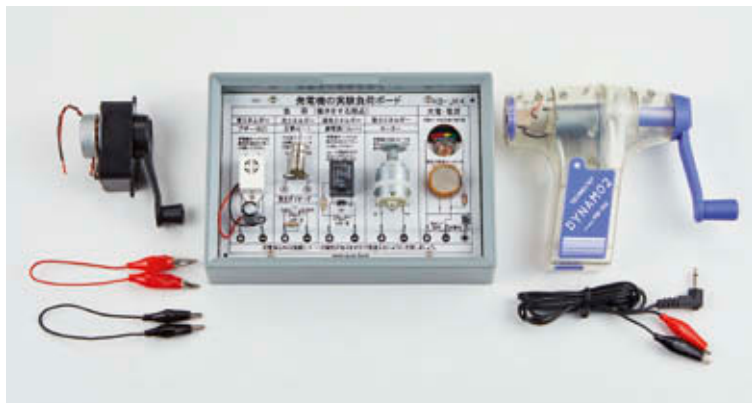
付属の発電機を使い、部品に電気負荷をかけて実験します。
