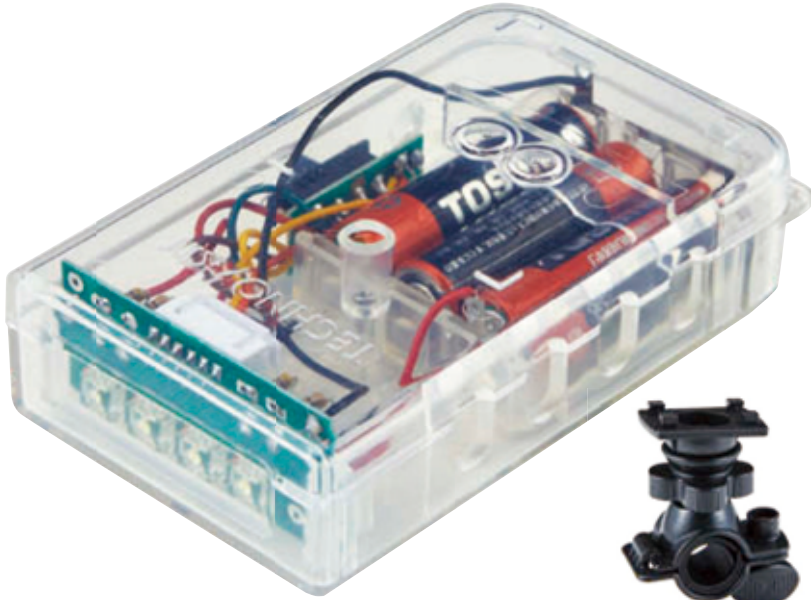
製作箇所 取付部品数=10 はんだ付け箇所=36
