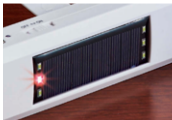
ブザーと同時に赤色 LED 1 個点滅
